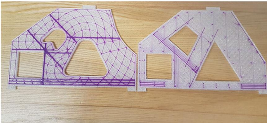
«Hone Structures» applique «Generative Design» aux structures en béton armé selon des stratégies de conception (algorithme)
